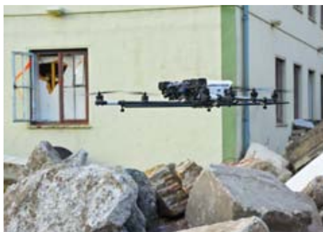
Die Mini-Drohne vom Typ „AscTec Falcon 8“ (eine Spende der „Ascending Technologies“) kann bis zu 750 Gramm Nutzlast bewegen, bis zu 20 Minuten lang fliegen und wiegt je nach Konfiguration allerhöchstens 2,2 Kilogramm. Hier beim Flug über ein Trainingsgelände.
